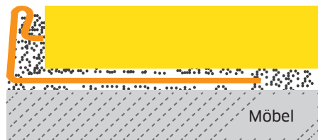
■ Querschnittbild des Profils Schlüter®-Schiene-E
